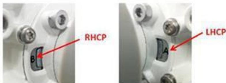
Рисунок 1 положение поляризации трансивера
