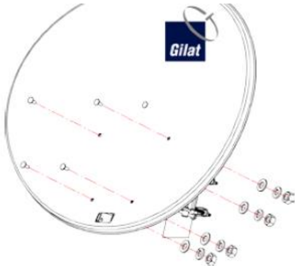
Рисунок 9. Отражатель со вставленными болтами Рисунок 10. Отражатель, закреплённый на заднем кронштейне
